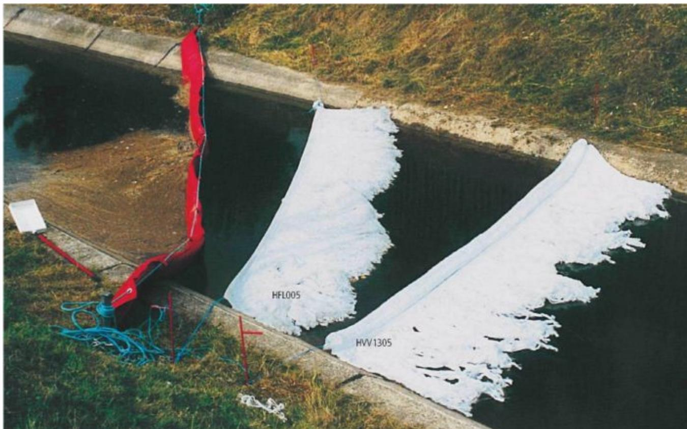
Заключительная обработка водной поверхности с помощью гидрофобного «ловца загрязнения» HFL005 и гидрофобного впитывающего рукава с полосками HW1305.
