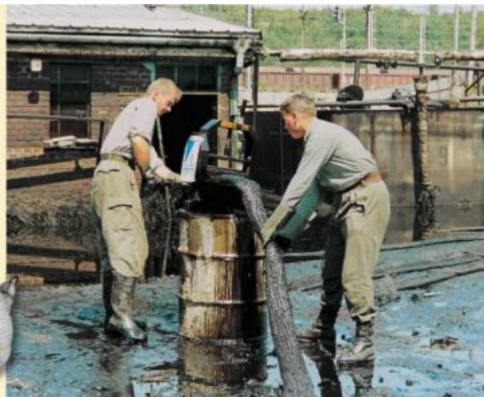
Регенерация впитывающих абсорбентов (рукавов, матов и других абсорбентов) с помощью REO202. Абсорбенты могут быть использованы неоднократно.
